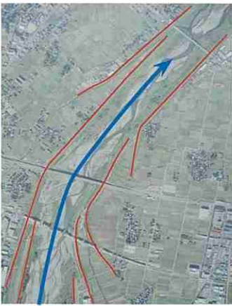
常願寺川河口より5.1キロメートルの霞堤上空写真(国土交通省北陸地方整備局富山河川国道事務所提供)
